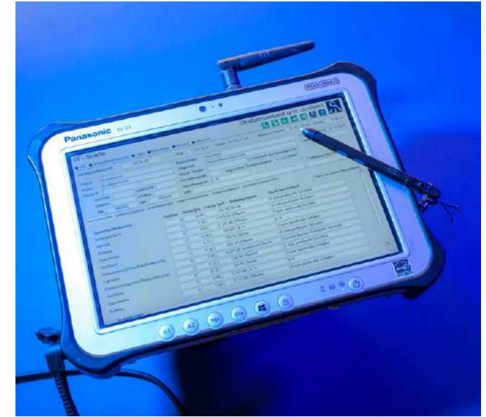
▲ Außendienstgerät zur Erfassung von Straßenzustandsdaten. Superrobust und damit für den Außeneinsatz geeignet.
